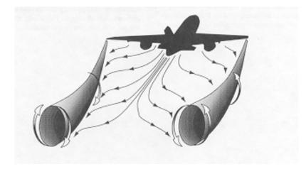
FIGURE 1. THE ROLLING UP PROCESS
